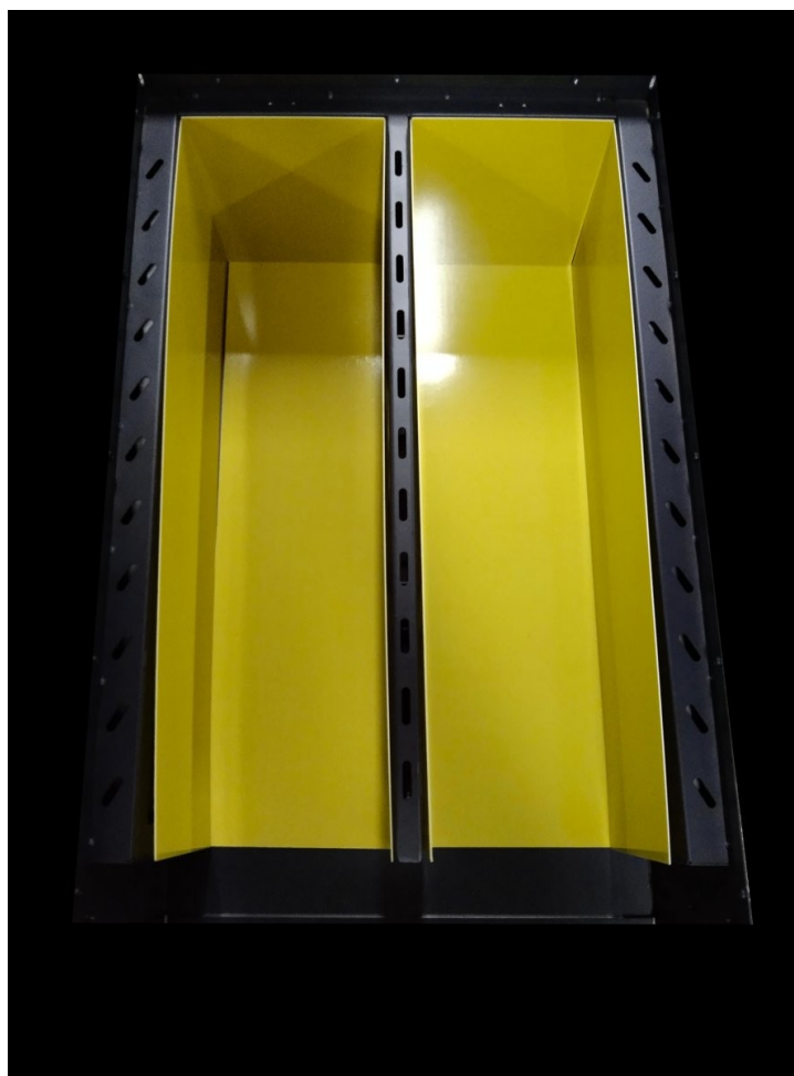
Корпус с установленной внутренней изоляцией
